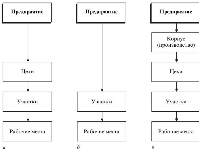
Рис. 5. Виды производственной структуры: а — цеховая; б — бесцеховая; в — корпусная
