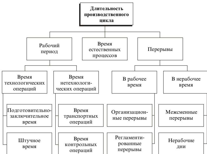
Рис. 8. Структура производственного цикла
