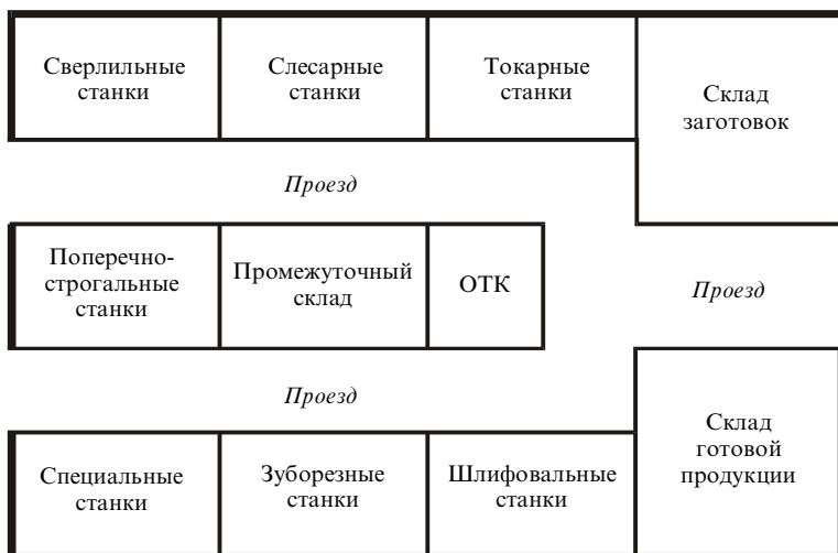
Рис. 10. Типичная непоточная (пооперационная) планировка производства
