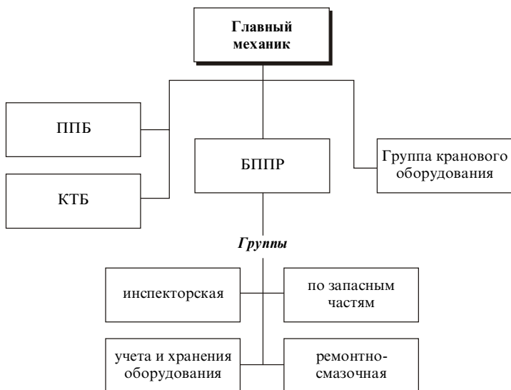
Рис. 14. Структура отдела главного механика на крупном предприятии: ППБ — планово-производственное бюро; КТБ — конструкторско-технологическое бюро; БППР — бюро планово-предупредительных ремонтов
