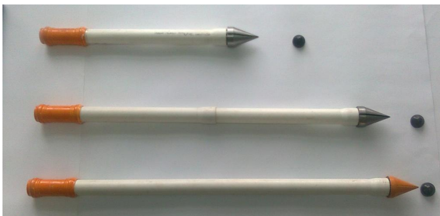
Рис. 2. Різні види конструкцій межового знаку у зібраному виді
